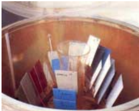
Test brouillard salin
